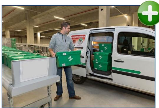
Les bacs isothermes permettent le maintien de la température pendant les opérations de chargement/déchargement
